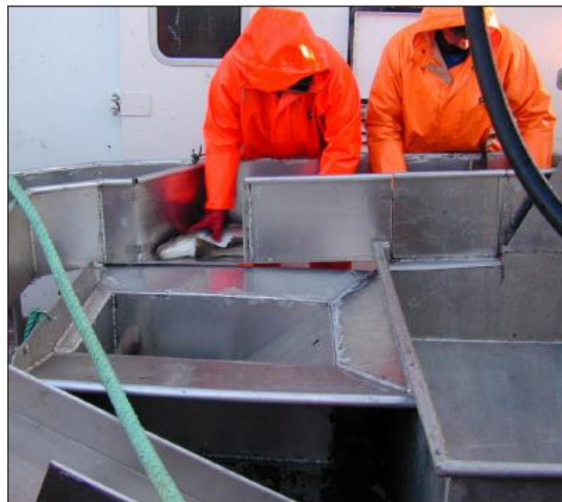
Bilde 30: Fisken slippes fra ordinær mottaksbinge ned i rennesystem hvor den sorteres og deretter slippes ned føringsrom.
