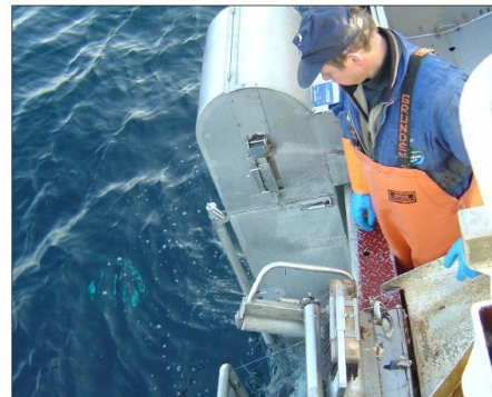
Bilde 3-4: Lina føres inn til «korten» hvor torskene avkrokes. Den faller deretter ned i vann og føres inn i linehalerens fangstkammer. En roterende heis fører så torskene opp på dekk. Torskene vurderes av mannskapet og har den lite sårskader og er vital, overføres den til lagringstanken. Lagringstanken er utviklet for denne flåtegruppen (< 15 meter) og er utstyrt med oppstrømsystem (se forovrig snurrevad-transporttanker).
